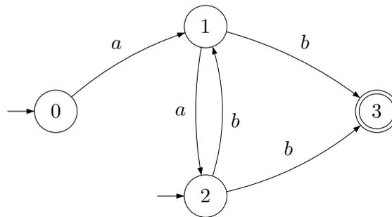
**Définition 1.7 :** Soit  $\mathcal{A} = (A, Q, I, E, T)$  un automate fini. On appelle **calcul** dans  $\mathcal{A}$  toute suite de transitions  $(q_i \xrightarrow{a_i} q_{i+1})_{i \in [1, n-1]}$  tel que l'extrémité d'une transition est l'origine de la suivante. On note un tel calcul de la façon suivante :
